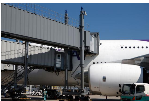
A380用搭乗橋(Aviation Wireから)
